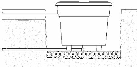
3.5.- Perforar la caseta por el lado que se ha previsto entrar con la alimentación eléctrica a un diámetro conforme al cable que se vaya a instalar. Determinar la sección del cable en función a la potencia consumida y a la caída de tensión. Instalar en la entrada prevista un prensaestopas adecuado a la sección de cable. Se recomienda proteger el cable, en su recorrido, con un tubo adecuado.
