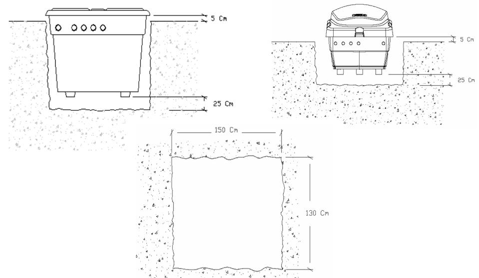
3.2.- Efectuar una losa de hormigón correctamente nivelada.
