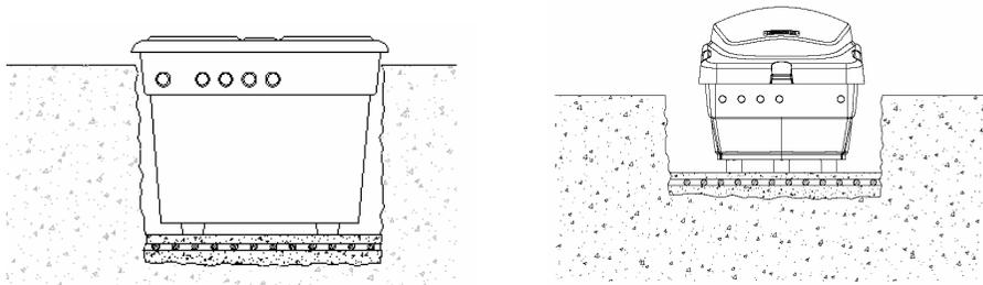
3.4.- Efectuar la excavación para preparar la canalización de las tuberías de ida y retorno a la piscina y de la alimentación eléctrica.
