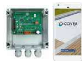
APP COVER CONNECT de serie con receptor Bluetooth integrado en el pie de OCTEO
