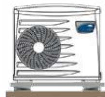
Plataforma de inercia
