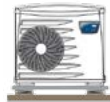
Plataforma de inercia
